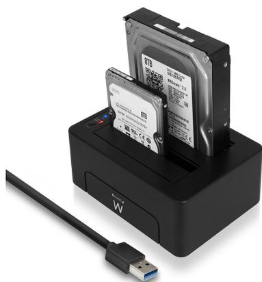
Ewent EW7014. Type de support de stockage: HDD, SSD, D'interface pour unité de stockage: Série ATA III, Tailles de disque de stockage pris en charge: 2.5,3.5". Interface de l'hôte: USB 3.2 Gen 1 (3.1 Gen 1) Type-A. Taux de transfert de données maximal: 5 Gbit/s, Couleur du produit: Noir, Matériel: Synthétique ABS. Largeur: 149 mm, Profondeur: 117 mm, Hauteur: 61 mm. Largeur du colis: 205 mm, Profondeur du colis: 75 mm, Hauteur du colis: 167 mm
